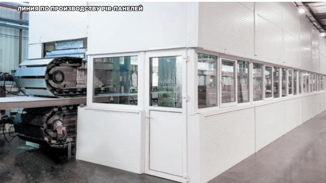
ЦЕХ ПРОИЗВОДСТВА PIR-ПАНЕЛЕЙ: УЧАСТОК СМЕШЕНИЯ И ЗАЛИВКИ PIR-КОМПОНЕНТОВ
